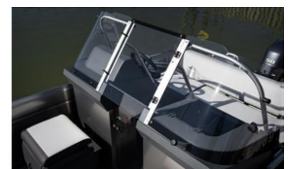
Den faste døren mellom konsollene beskytter passasjerer mot vind og sprut.
